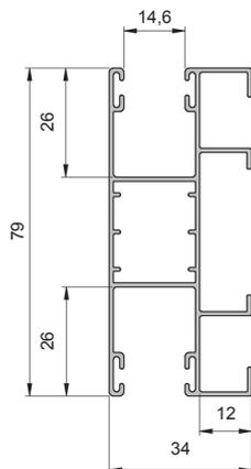
**PPD79/ODS/G/x** - z uszczelką gumową, do profili: PT 37, PA 37, PA 39, PA 40, PE 41, PA 45, boków skrzynek i pokryw bocznych ze stopką typu I
