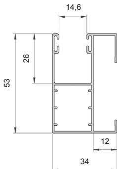
**PP53/ODS/G/x** - z uszczelką gumową, do profili: PT 37, PA 37, PA 39, PA 40, PE 41, PA 45, boków skrzynek i pokryw bocznych ze stopką typu I
