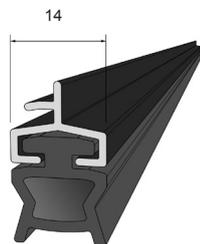
Listwa dolna aluminiowa z uszczelką gumową
